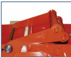
Schlaffseilschalter (3) Slack-rope switch (3) Détection de brin mou (3)
