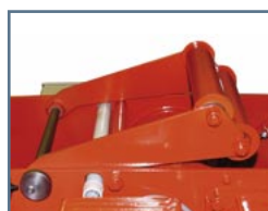
Schlaffseilschalter Slack-rope switch Détection de brin mou
