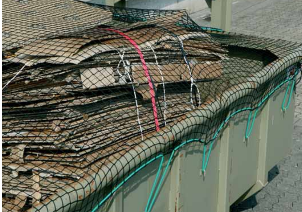
Abdecknetz mit Gummi-Spannleine (s. S. 20)
